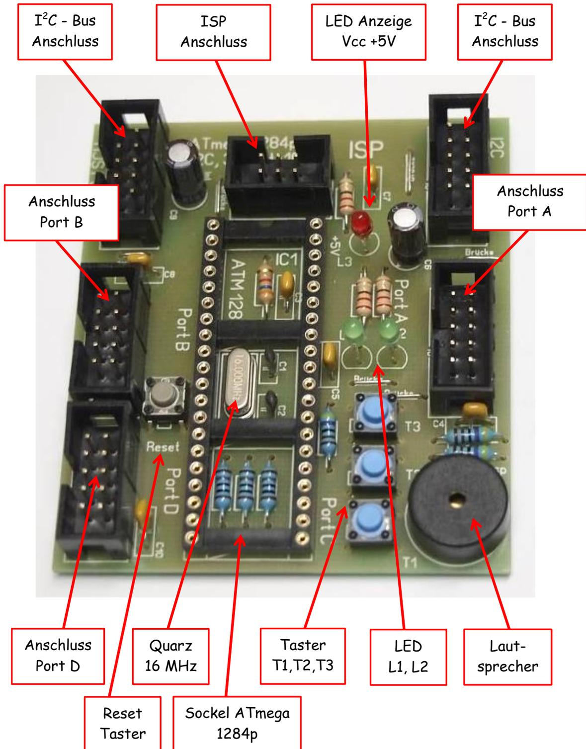
Einige Bauteile wurden innerhalb des Sockels eingebaut. Nachdem der ATmega 1284p eingesteckt wird, sind diese Bauteile nicht mehr sichtbar.
